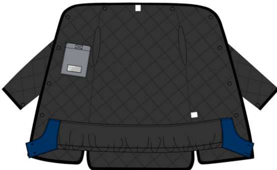
Рисунок А.4 – Эскиз внутреннего вида съёмной утеплённой подкладки куртки, модель ИР-зима-Сварщик-2-IV-хим/хб-КБр, ИР-зима-Сварщик-3-IV-хим-КБр
