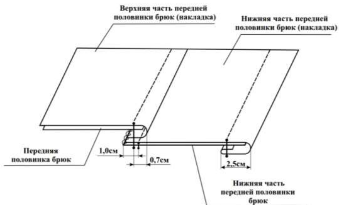
Рисунок Е.9 – Схема обработки нижней части передней половинки брюк, модели ИР-зима-Сварщик-2-IV-хб-КБр, ИР-зима-Сварщик-2-IV-хим-КБр, ИР-зима-Сварщик-3-IV-хб-КБр
