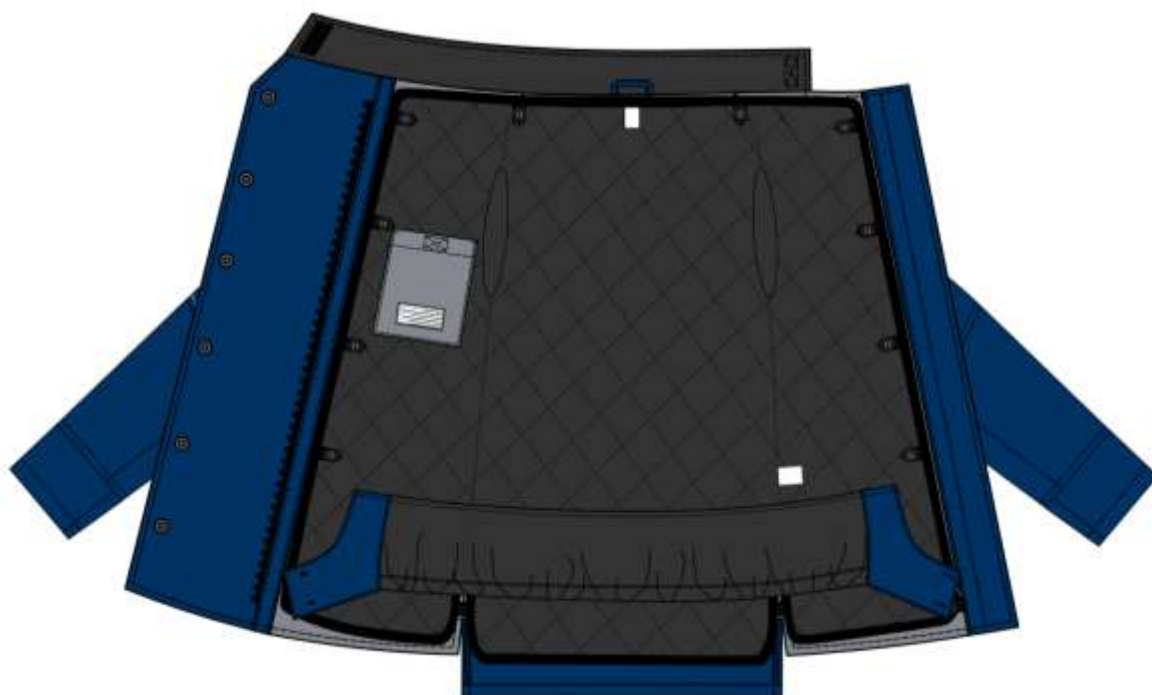
Рисунок А.5 – Эскиз внутреннего вида куртки, модели ИР-зима-Сварщик-2-IV-хим/хб-КБр, ИР-зима-Сварщик-3-IV-хим-КБр
