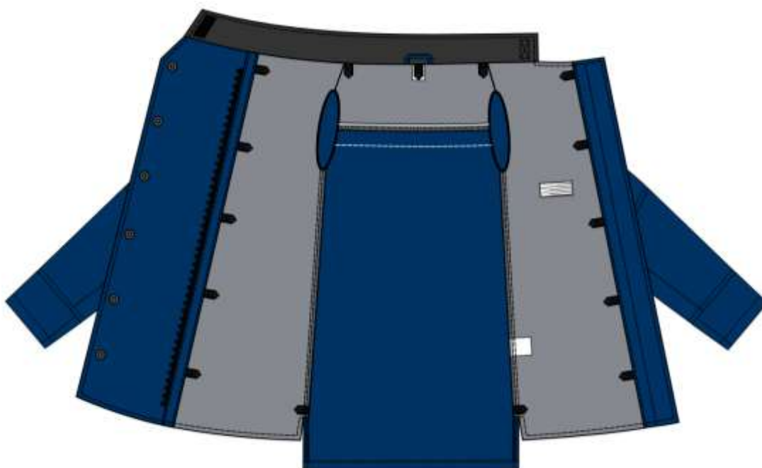
Рисунок А.2 – Эскиз внутреннего вида куртки, модели ИР-зима-Сварщик-2-П-Ш-хим/хб-КБр, ИР-зима-Сварщик-3-П-Ш-хим-КБр
