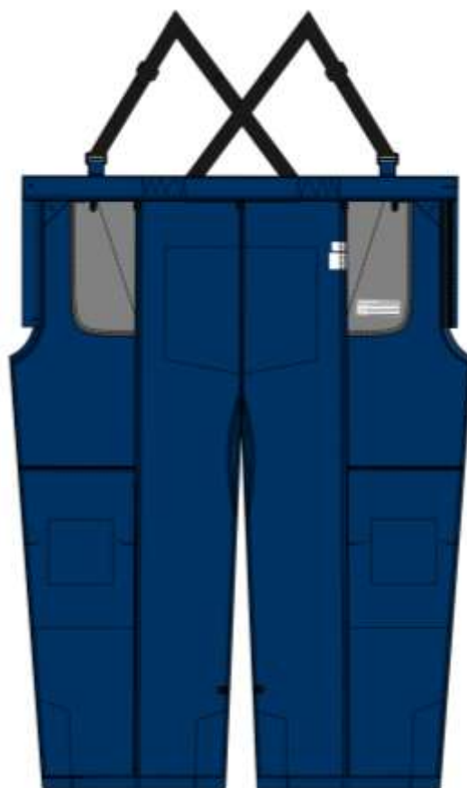
Рисунок А.6 – Эскиз внутреннего вида брюк, модели ИР-зима-Сварщик-2-П-III-хб-КБр, ИР-зима-Сварщик-2-П-III-хим-КБр, ИР-зима-Сварщик-3-П-III-хб-КБр
