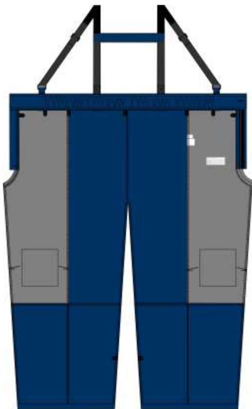
Рисунок А.8 – Эскиз внутреннего вида брюк, модели ИР-зима-Сварщик-3-II-III-хим-КБр
