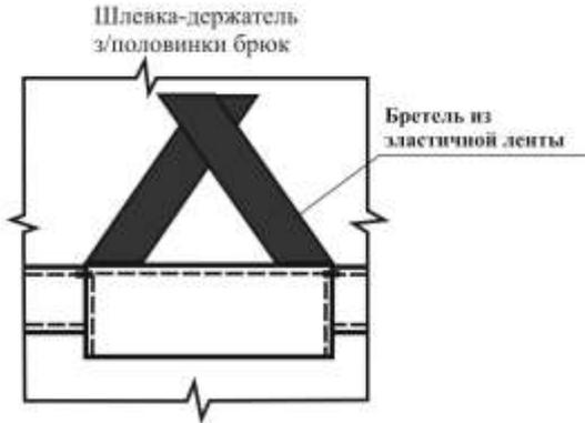
Рисунок Е.2 – Схема расположения закрепок костюмов, модели ИР-лето-Сварщик-2-хим/хб-КБр
